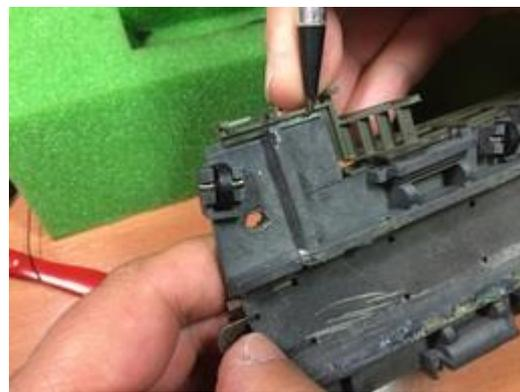
Desmontaje de la escalerilla del puente
