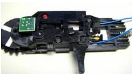
Instalación del sensor infrarrojo y reflector de 4 encastres en sustitución de la corredera y la bobina/relé
