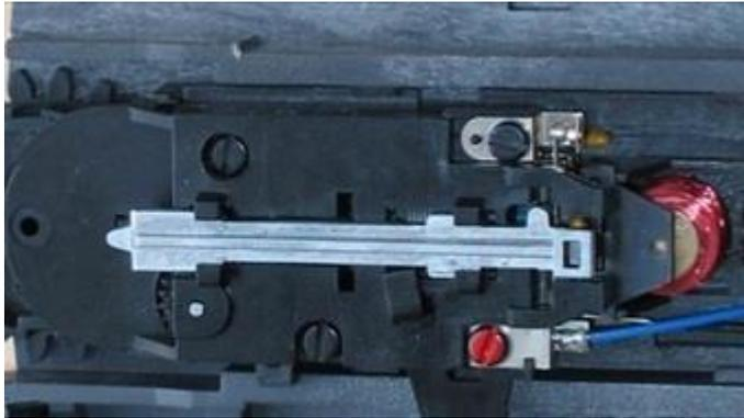
Figure 8 Detail de la tige de verrouillage
